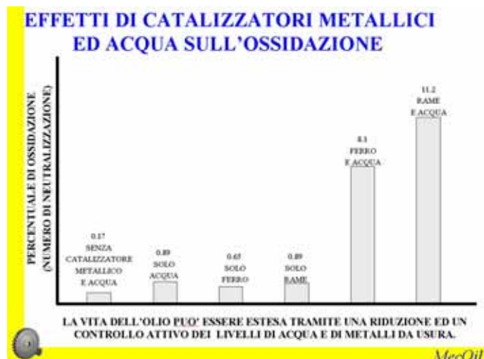
Figura 4 – Effetti di catalizzatori metallici ed acqua sull'ossidazione
