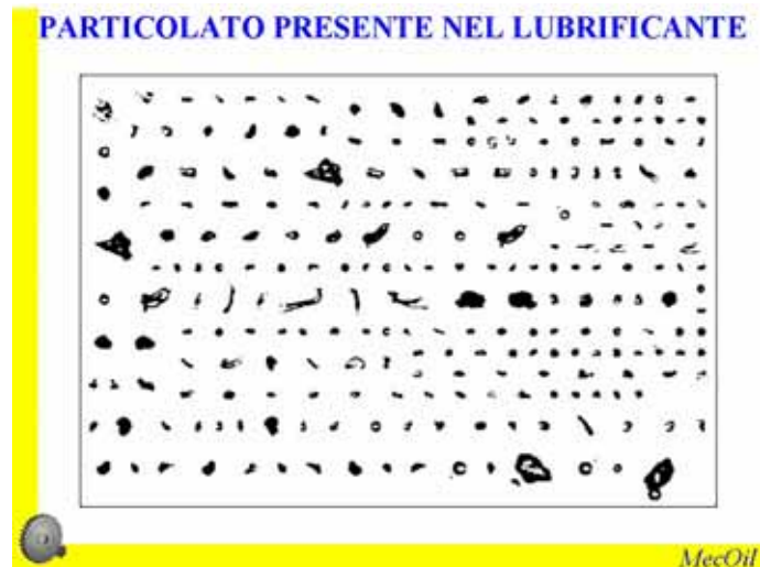
Figura 5 – Particolato presente nel lubrificante
